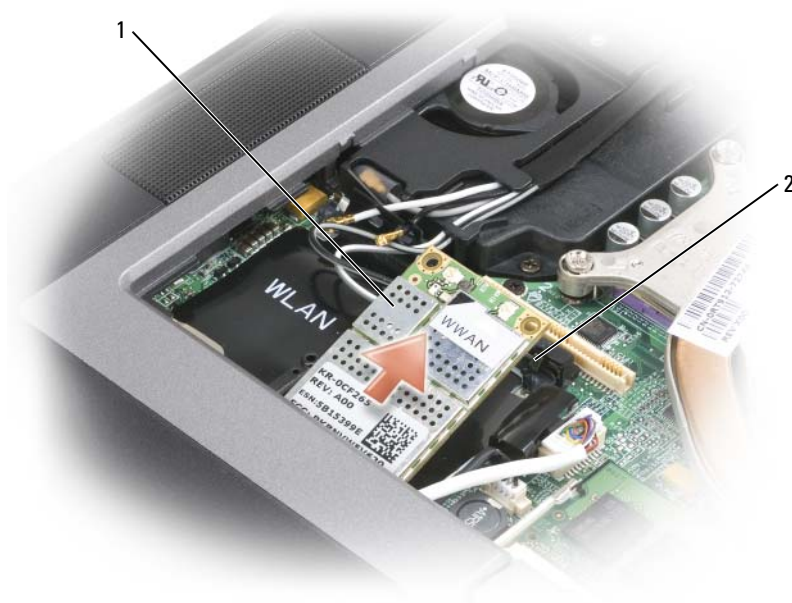
1 carte haut débit mobile 2 pattes métalliques de fixation (2)
